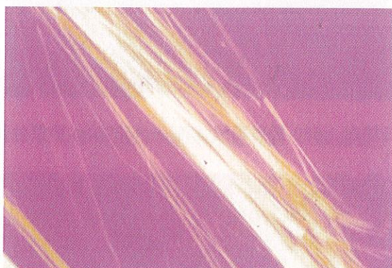
图 C.2 温石棉在 1.550 折射率浸渍液——530 nm 补偿片正交偏光图
