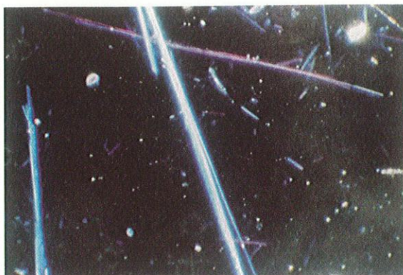
图 C.22 阳起石在 1.630 折射率浸渍液中的色散染色图(淡蓝色纤维在消光位置)
