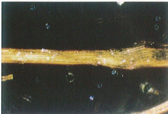
图 C.27 透闪石在 1.605 折射率浸渍液中的色散染色图(纤维平行于起偏器的偏振方向)
