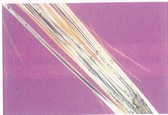
图 C.6 铁石棉在 1.680 折射率浸渍液——530 nm 补偿片正交偏光图
