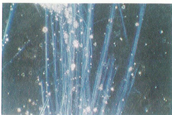
图 C.14 青石棉在 1.700 折射率浸渍液中的色散染色图(纤维垂直于起偏器的偏振方向)
