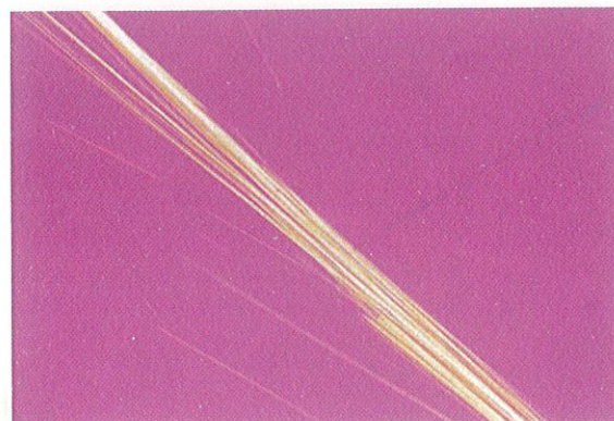
图 C.24 直闪石在 1.605 折射率浸渍液——530 nm 补偿片正交偏光图
