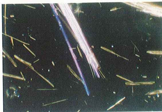
图 C.18 透闪石在 1.605 折射率浸渍液中的色散染色图(纤维在消光位置)
