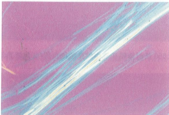
图 C.1 温石棉在 1.550 折射率浸渍液——530 nm 补偿片正交偏光图
