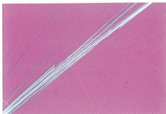
图 C.23 直闪石在 1.605 折射率浸渍液——530 nm 补偿片正交偏光图
