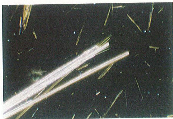
图 C.17 透闪石在 1.605 折射率浸渍液中的色散染色图(纤维在消光位置)
