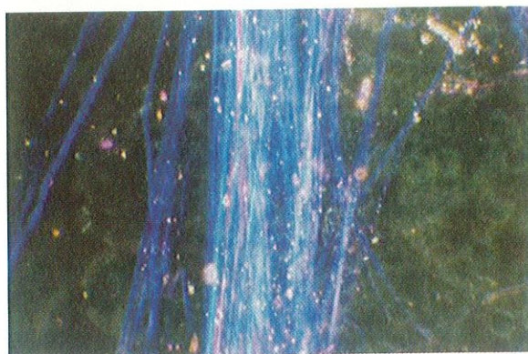
图 C.4 温石棉在 1.550 折射率浸渍液中的色散染色图(纤维垂直于起偏器偏振方向)
