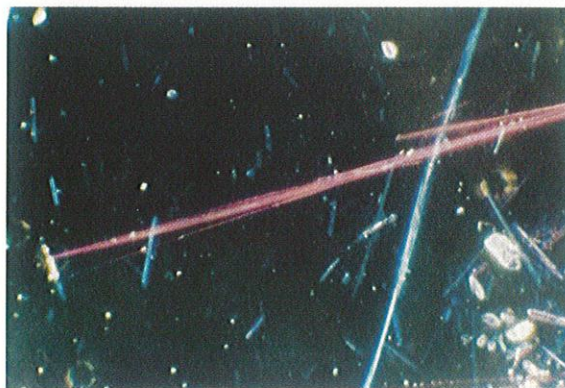
图 C.21 阳起石在 1.630 折射率浸渍液中的色散染色图(紫色纤维在消光位置)
